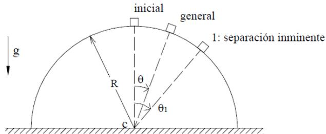
Un pequeño bloque se coloca sobre una superficie circular lisa de radio  $R$ . Podría ser bien una superficie esférica o cilíndrica, cuyo corte vertical es el círculo mostrado. Se le da al bloque una pequeñísima velocidad inicial en el punto más alto ( $v_o \approx 0$ ), de modo que baja deslizando por la superficie. Para la posición 1 en la que se despega de la superficie, hallar el ángulo  $\theta_1$  y la velocidad  $v_1$ .
