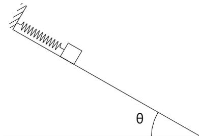
Un resorte de constante  $k$  tiene un extremo fijo a la parte superior de un plano inclinado. Al otro extremo está sujeto un bloque de masa  $m$  que se suelta desde la longitud natural del resorte y baja deslizándose por el plano inclinado liso. Hallar la velocidad del bloque como función de la posición. ¿Cuál es la máxima deformación del resorte? ¿En qué posición adquiere el bloque su máxima velocidad?
