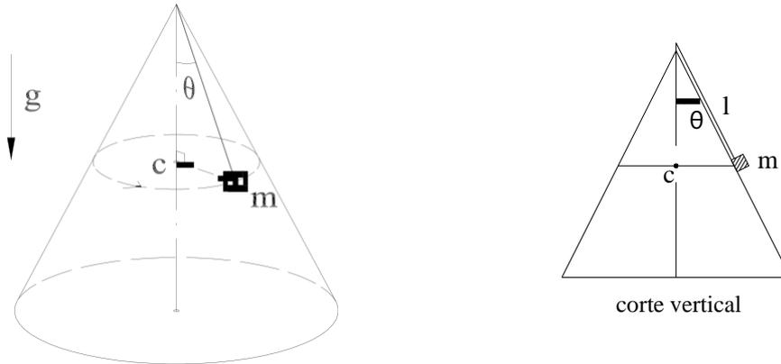
Una partícula de masa  $m$  describe un círculo horizontal, apoyada en una superficie cónica lisa y sostenida por una cuerda de longitud  $l$ . Si la velocidad angular es  $\omega$ , hallar la tensión en la cuerda y la reacción de la superficie.
